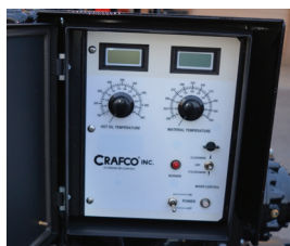
Controles digitales para exactitud de la temperatura
