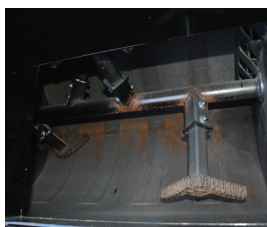
Paletas de agitación inclinadas y en ángulo para una mezcla completa del material y para sostener la suspensión de agregados
